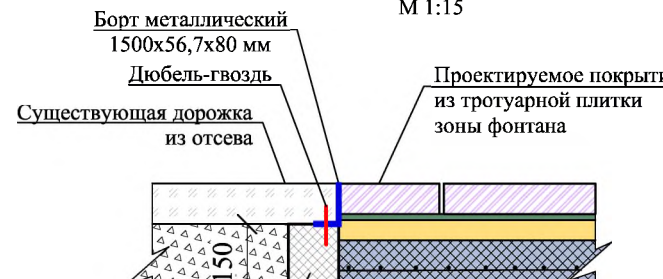
Узел установки металлического борта М 1:15
